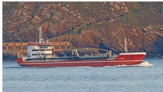
Ce navire, selon les indications de l'armateur, remplit ses ballasts et ses cales dans les ports d'opération avant de déballaster sur la zone d'aspiration et de rejeter et de remplacer les eaux par du sable extrait de Cairnstrath SN2.
