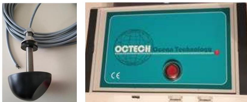
Figure 1 : photos d'un transducteur fixé à la coque (à gauche) et d'un boîtier en passerelle (à droite)
