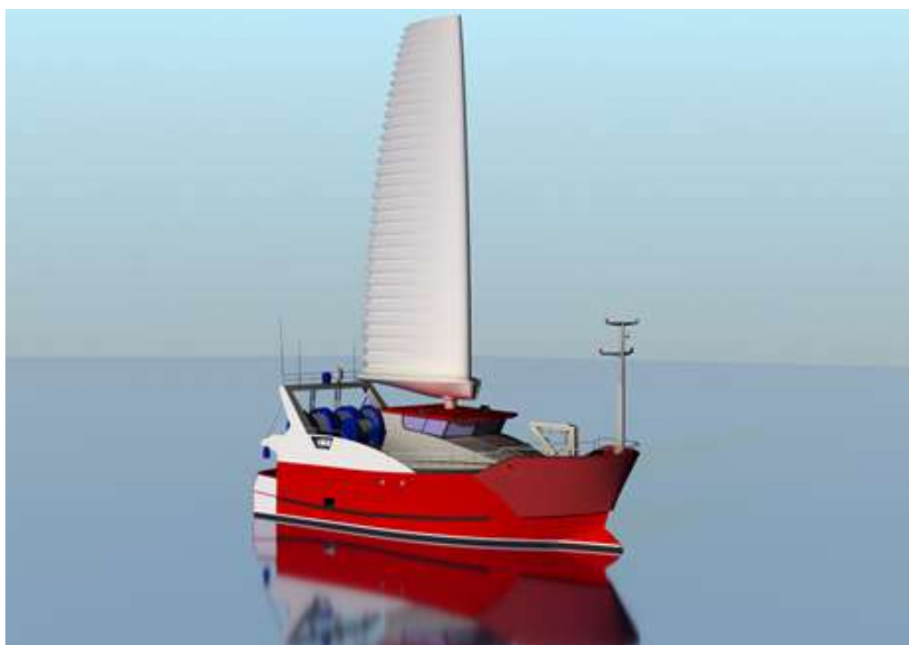
Vue 3D de l'intégration de la voile sur un chalutier - Source : Wisamo.
