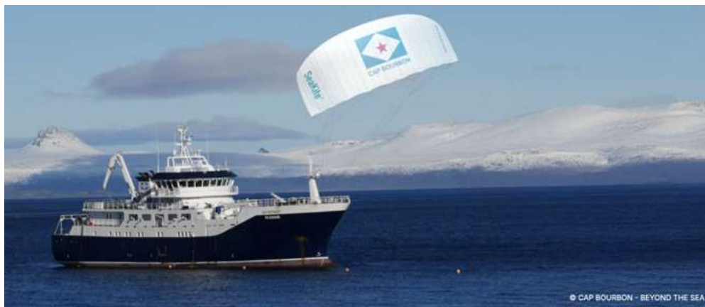
Projection du système de traction installé sur le palangrier Cap Kersaint - Source : Cap Bourbon - Beyond the Sea.
