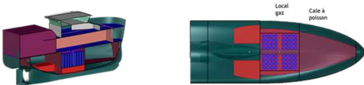
Représentation du système de stockage pour un navire de pêche de 20,50 m - Source : France Pêche Durable et Responsable
