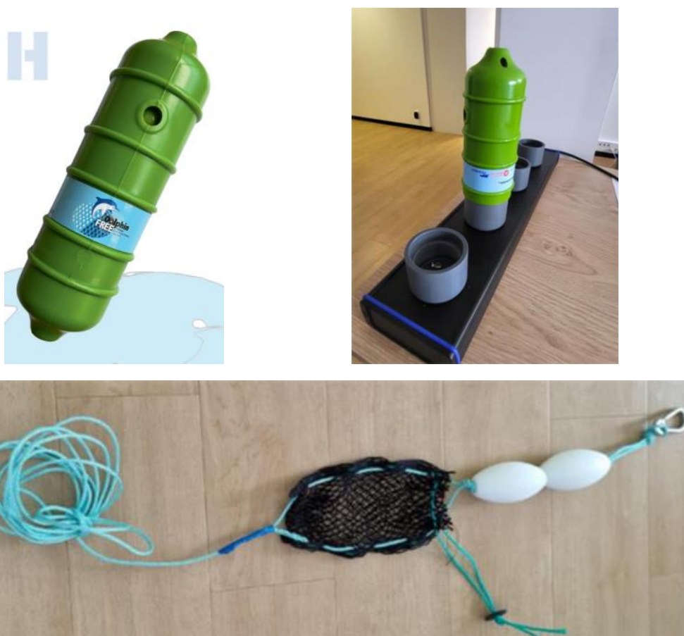
Figure 1 : Photo d'une balise (en haut à gauche), d'un chargeur (en haut à droite) et du kit de fixation (en bas)
